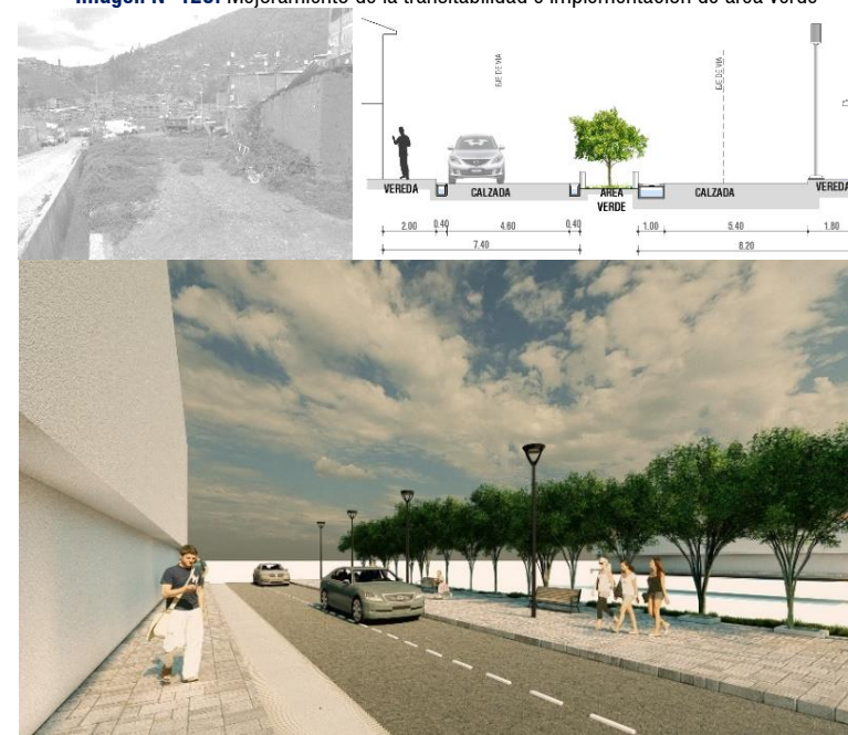
Imagen N° 123: Mejoramiento de la transitabilidad e implementación de área verde
